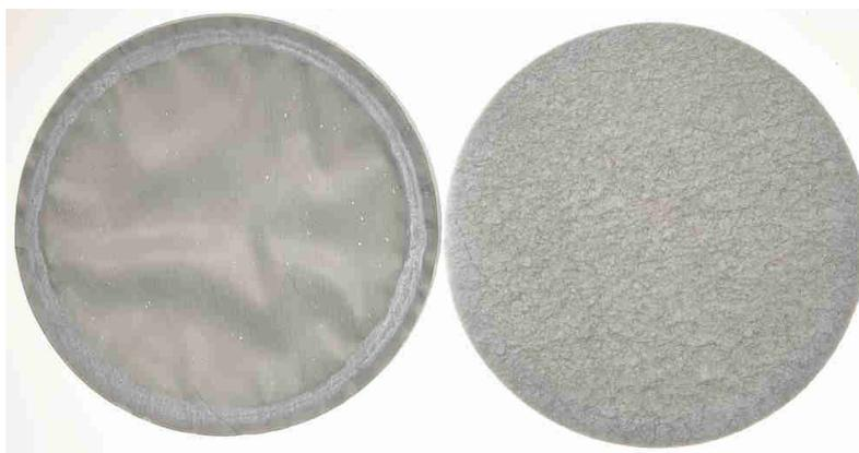
Eine Kombination unterschiedlicher Membrantypen führt zu einem hohen Luftdurchlasswert und Partikelretention.
